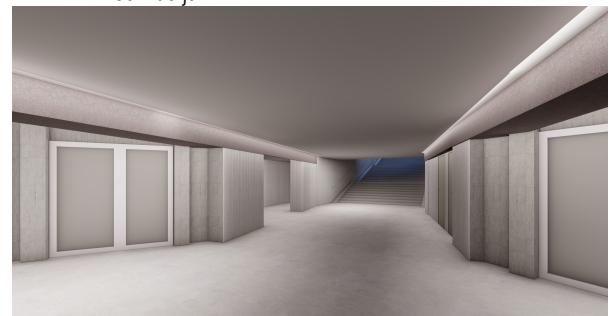
6. Tunelio interjero vizualizacija. Matomi sienų, grindų, lubų bei apšvietimo sprendiniai.
