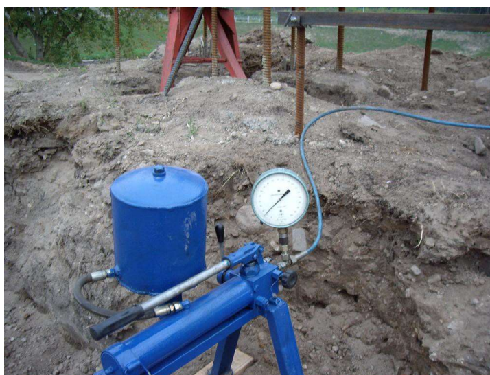
12.3 pav. Rankinė hidraulinė siurblinė
