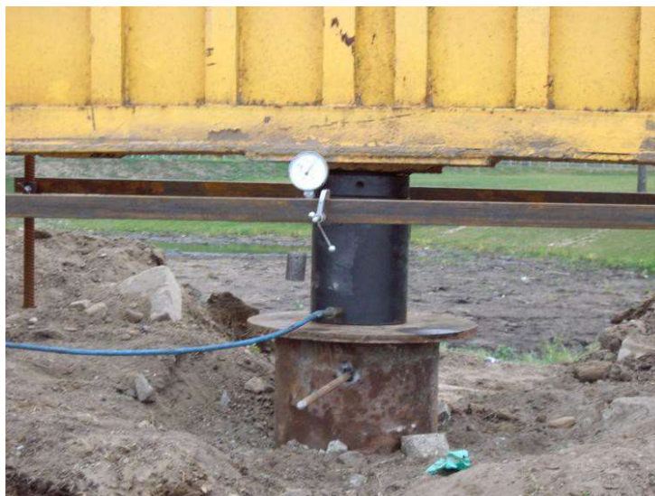
12.4 pav. Nuosėdžių matavimo indikatorius sumontuotas ant nepriklausomo sijyno
