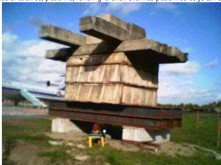
12.1 pav. Minimalus atsvaros sistemos svoris privalo viršyti maksimalią bandymo apkrovą 20 %.
